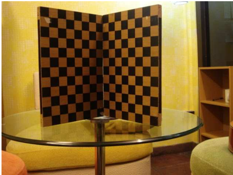
Slika 24: 3D kalibracijski kavez sastavljen od dvije ravnine pod kutem od 90 stupnjeva
