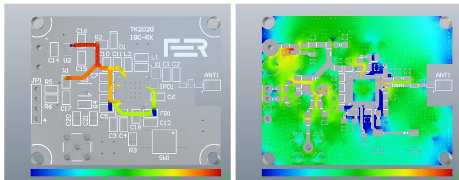
Sustav za mjerenje snage signala realiziran je na dvoslojnoj tiskanoj pločici. Ključne komponente sustava su logaritamsko pojačalo **AD8310**, mikrokontroler **STM32WB55CG** i Bluetooth antena za prijenos podataka.
